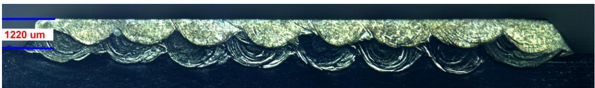
Kettő rétegű felhegesztés az alapanyaggal nem azonos felhegesztő anyaggal köszörülés után vastagságméréssel
