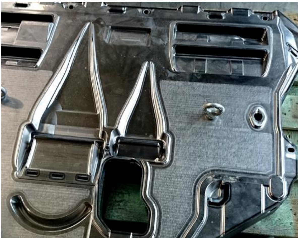
Autóipari kivágó szerszám vágóéleinek edzése
